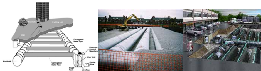
Figura 24 – Esempio di strutture di laminazione costituite da tubazioni sotterranee e sovradimensionamento del sistema di drenaggio delle superfici impermeabili
